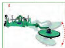
Vérin d'inclinaison avec position flottante
