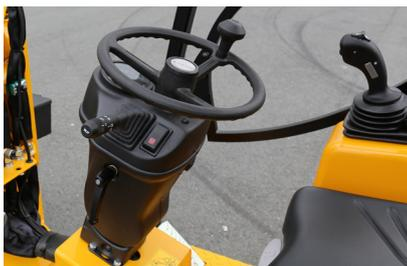
La colonne de direction est réglable. En plus d'être commode, cela facilite la montée et la descente.
