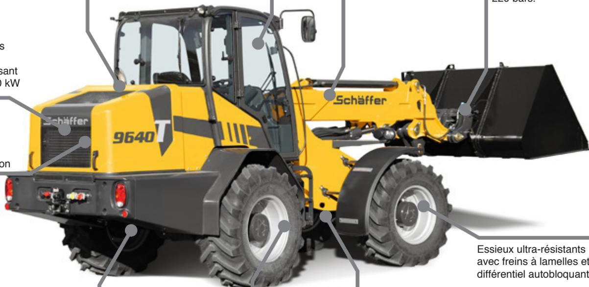
Essieu pendulaire à l'arrière pour plus de stabilité. En option, suspension de l'essieu
