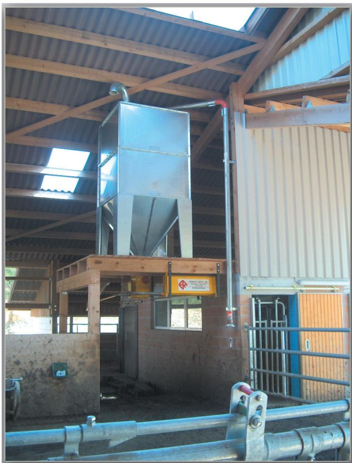
Silo en exécution, zingué et vissé, entonnoir 40° ou 60°. Hauteur maximum 5 éléments (4,50 m). Parois en tôle zinguée, avec nervures de renforcement.
