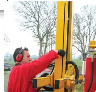
Molette pour réglage de la profondeur d'enfoncement
