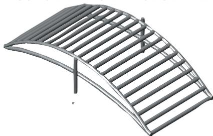
Pour VTT et piétons. Galvanisé à chaud, espace entre barreaux 10 cm, longueur 190 cm, largeur 80 cm, hauteur 35 cm, diamètre des barreaux : latéraux 48,3 mm, couverture 42,4 mm.
