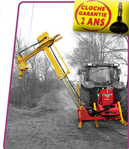
VIBRESCOPIC PRO, inclinaison hydraulique intérieur 18° / extérieur 25°
