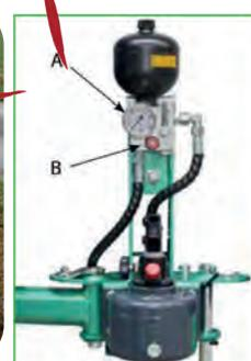
Für alle Gelände geeignet dank der unabhängigen Anpassung der Verschiebungsflexibilität (A) und der Rückkehrgeschwindigkeit des Armes (B).
