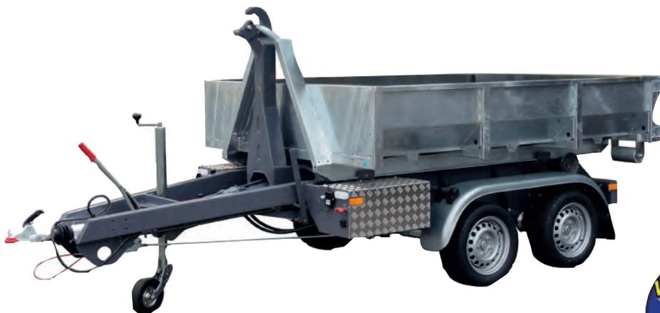
KONOS ist eine universale Kippmulde mit dem Gesamtgewicht bis zu 3500 kg. Bedienung unabhängig durch eine Elektrohydraulikpumpe mit Funk-Fernbedienung. Der Rahmen des Kippmechanismus ist verschweisst und lackiert.
