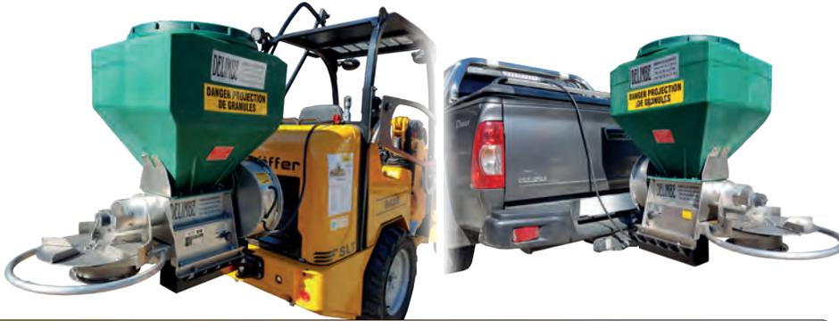
Der Salzstreuer T11 ist mit einem 80 oder 120 Liter Vorratsbehälter aus Kunststoff und stabilem Rahmen ausgestattet.
