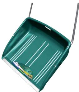
Zur Schneeräumung jeglicher Flächen durch direktes Schieben des Schnees mit der Schneewanne, oder durch das Beladen der Schneewanne mit der Schaufel. Schneewanne großes Modell: 80 cm / 60 L, für eine bessere Leistung. Material Polymer: bleibt nicht am Schnee hängen. Röhrenförmiger Stahlrahmen: verstärkt die Struktur. Aluminiumleiste: verstärkt die Angriffskante
