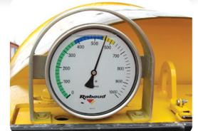
Füllanzeige mit Manometer sichtbar von der Kabine aus
