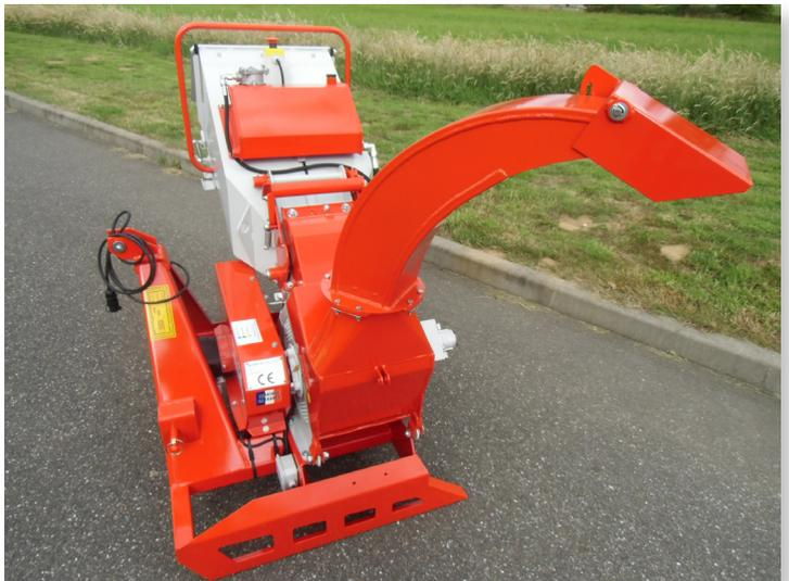
3 Punktenbau Zapfwelle 540 U/min. für kleinen Trayktor
