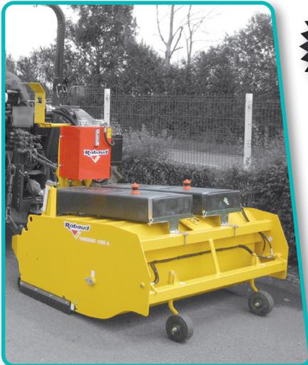
**TURBONET mit Hydraulikaggregat und Wassertanks**
