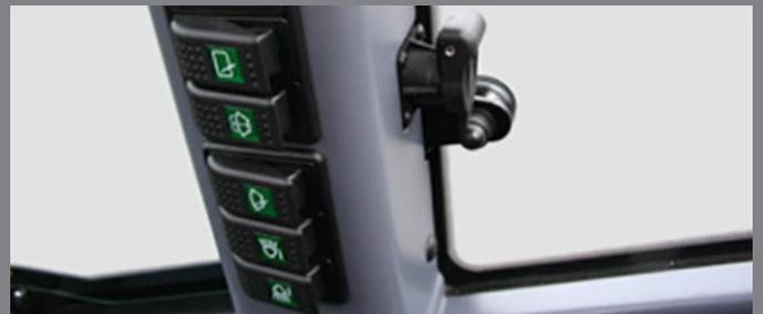
Zusammengefasste Schalterleiste, Steckdose mit Dauerstrom
