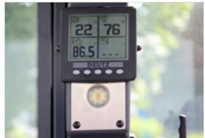
Neues Info-Display in der B-Säule für das Abgassystem (bei Ladern der 86er- und 96er-Serie)
