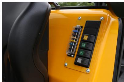
Die elektrischen Sicherungen können einfach kontrolliert und ausgetauscht werden.
