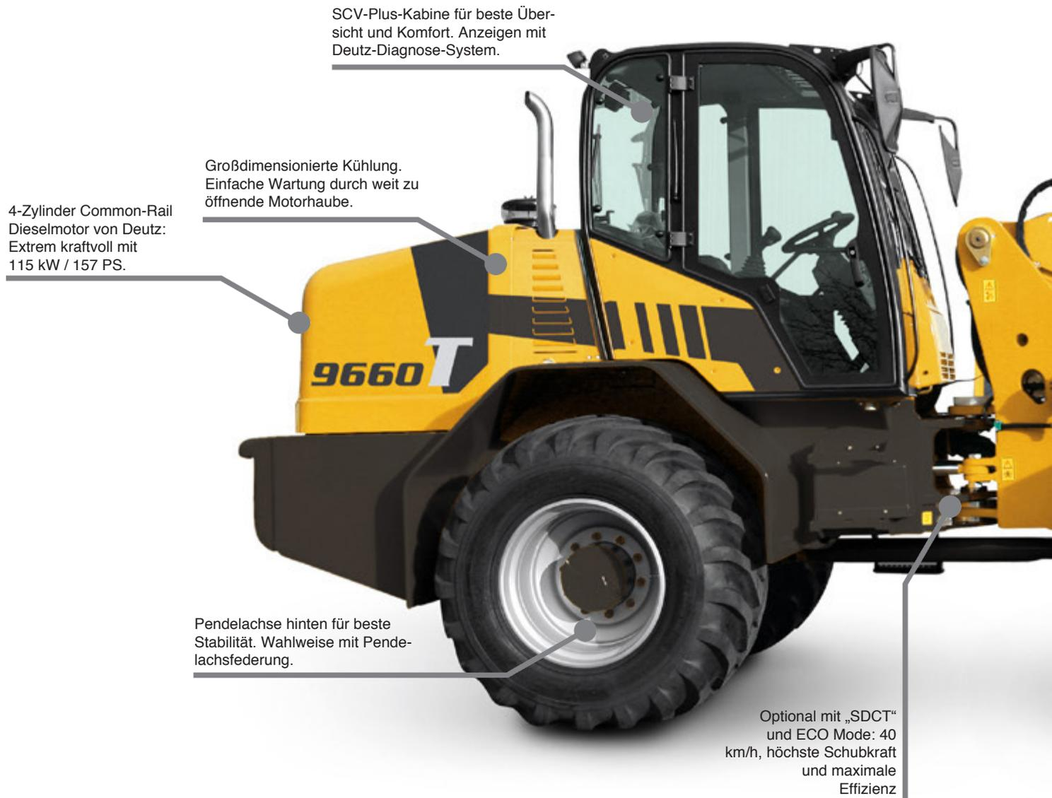
SCV-Plus-Kabine für beste Übersicht und Komfort. Anzeigen mit Deutz-Diagnose-System.
