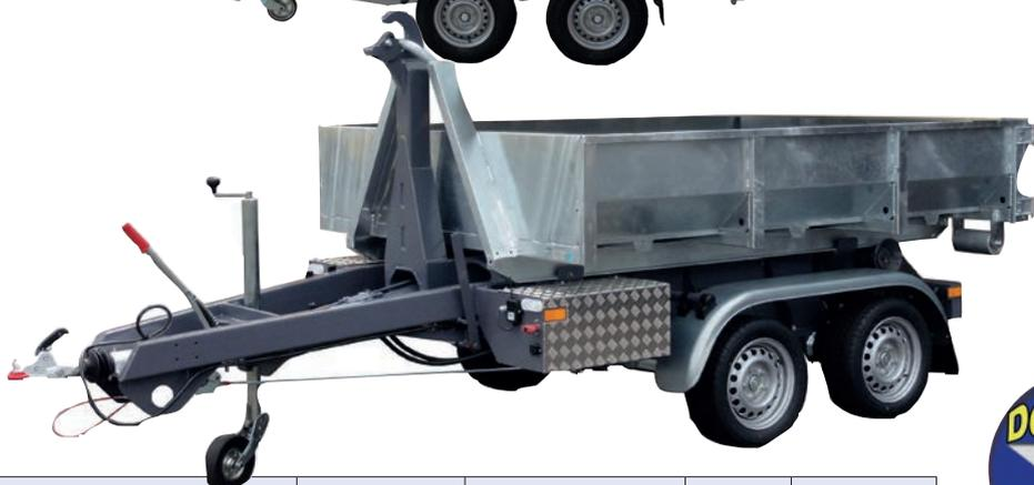
Remorque porte-caisson. Poids total à charge jusqu'à 3500 kg. Télécommande pour le système hydraulique permettant le chargement et le déchargement du caisson, ou son basculement vers l'arrière. Châssis galvanisé et caisson peint ou galvanisé.
