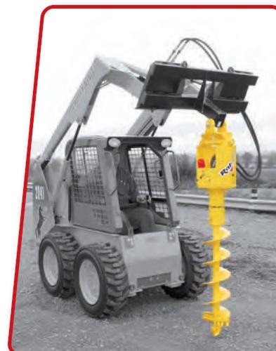
Tarière adaptable sur tout engin hydraulique inférieur à 15 tonnes; mini-pelle, tractopelle ou pelle. Une gamme de 8 modèles avec un très large choix de vrilles: de 100 à 800 mm interchangeables.
