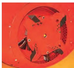
Rotor avec marteaux et couteaux pour paille courte.
