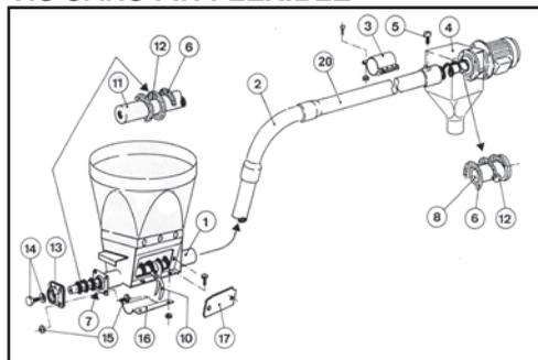
Vis sans fin flexible en acier dans un tuyau en PVC. Utilisées pour le transport des céréales, farines ou poudres industrielles. Livrables en diamètres 75 et 90 mm; dès une longueur de 3 m.
