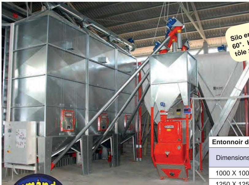
Silo en exécution zingué et vissé, entonnoir 40° ou 60°. Hauteur maximum 5 éléments (4,50 m). Parois en tôle zinguée, avec nervures de renforcement.
