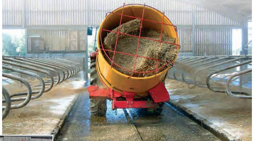
Chargement direct du tambour. Distribution de la paille par un ou deux côtés à l'aide de goulottes pouvant être ouvertes ou fermées. Convient pour l'alimentation ou le paillage. Le poids de la machine est proche de celui du tracteur, ce qui lui assure une bonne maniabilité.
