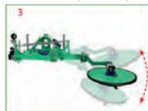
Vérin d'inclinaison avec position flottante
