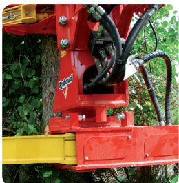
Couteau monté sur un support mobile (amplitude 38,5°) pour une coupe nette sans effort
