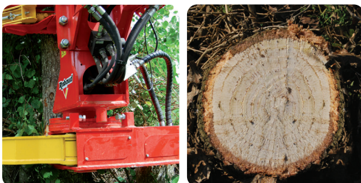
Couteau monté sur un support mobile (amplitude 38,5°) pour une coupe nette sans effort
