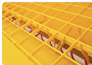
Rotor + vis avec filets à pas inversé
