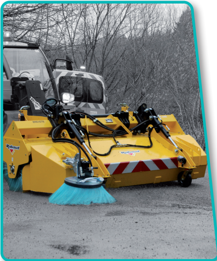
MULTINET 2400 avec options balai latéral, bac de ramassage hydraulique, 1 balai latéral
