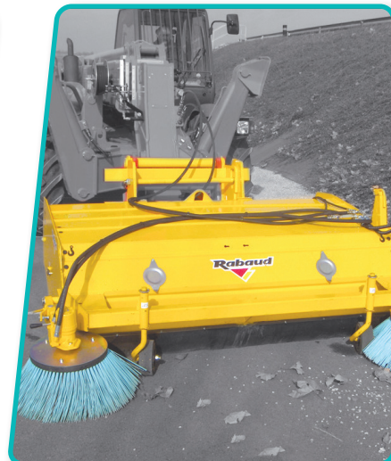
TURBONET 2000 A sur télescopique avec option 2 balais latéraux
